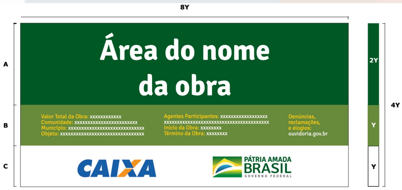
Figura 01 – Detalhe placa da obra
