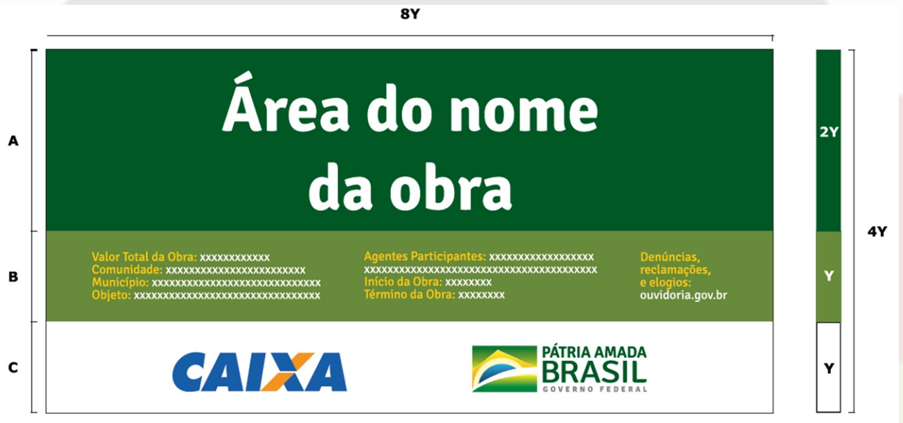
Figura 01 – Detalhe placa da obra
