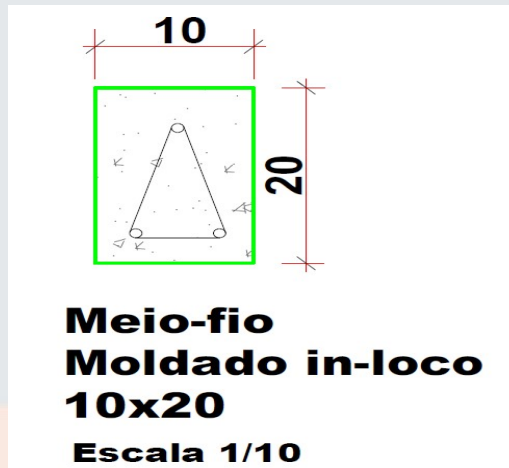
Figura 02 – Meio Fio Moldado in-loco
