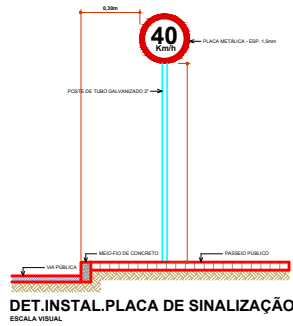
DET.INSTAL.PLACA DE SINALIZAÇÃO ESCALA VISUAL
