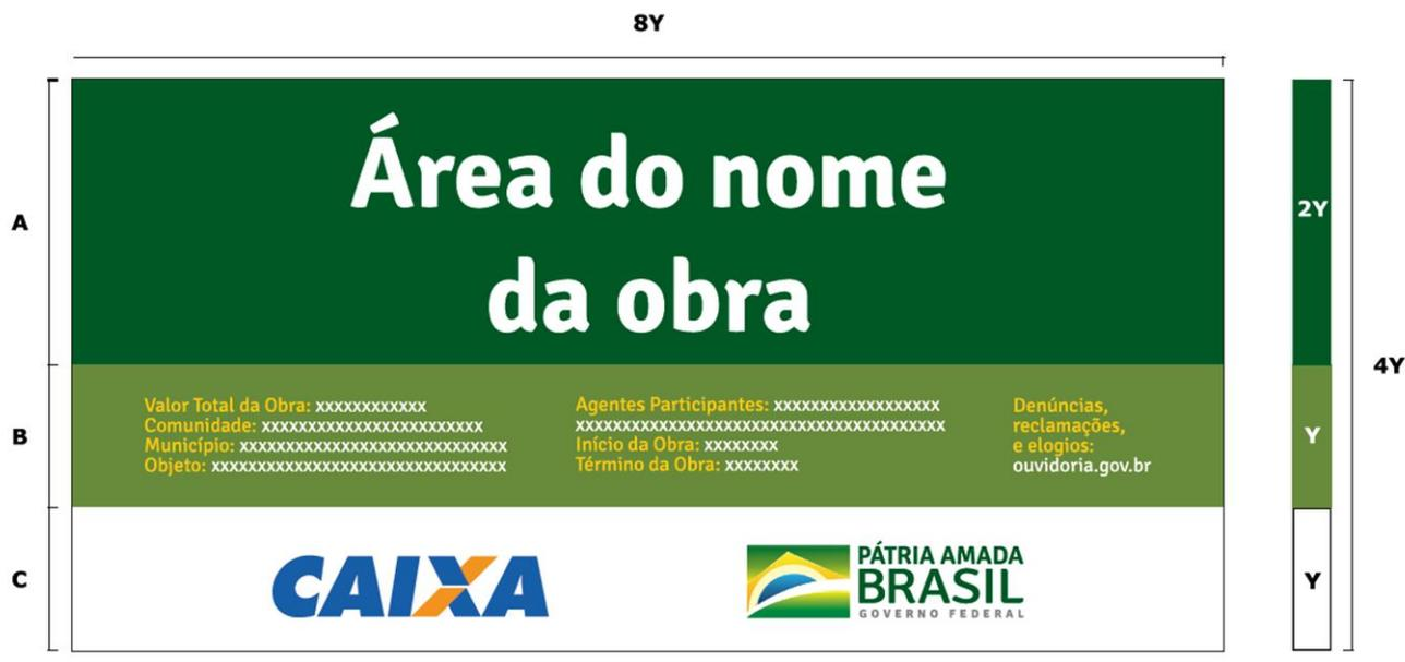
Figura 01 – Detalhe placa da obra
